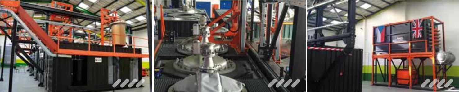
Samotný proces pomalého termického rozkladu (PTR) trvá cca 2–3 hodiny a probíhá v uzavřeném systému bez přístupu vzduchu. PTR proces jako takový je termicky stabilní a v jeho průběhu kontinuálně vznikají ze vstupní vsázký vždy **tři výstupní frakce: plynná, kapalná a pevná**. V závislosti na koncovém využití těchto frakcí jsou výstupy procesu PTR certifikovány jako paliva, např. HEDGAS (PTR plyn), HEDOIL (PTR olej) a HEDCARB (PTR uhlík).\*
